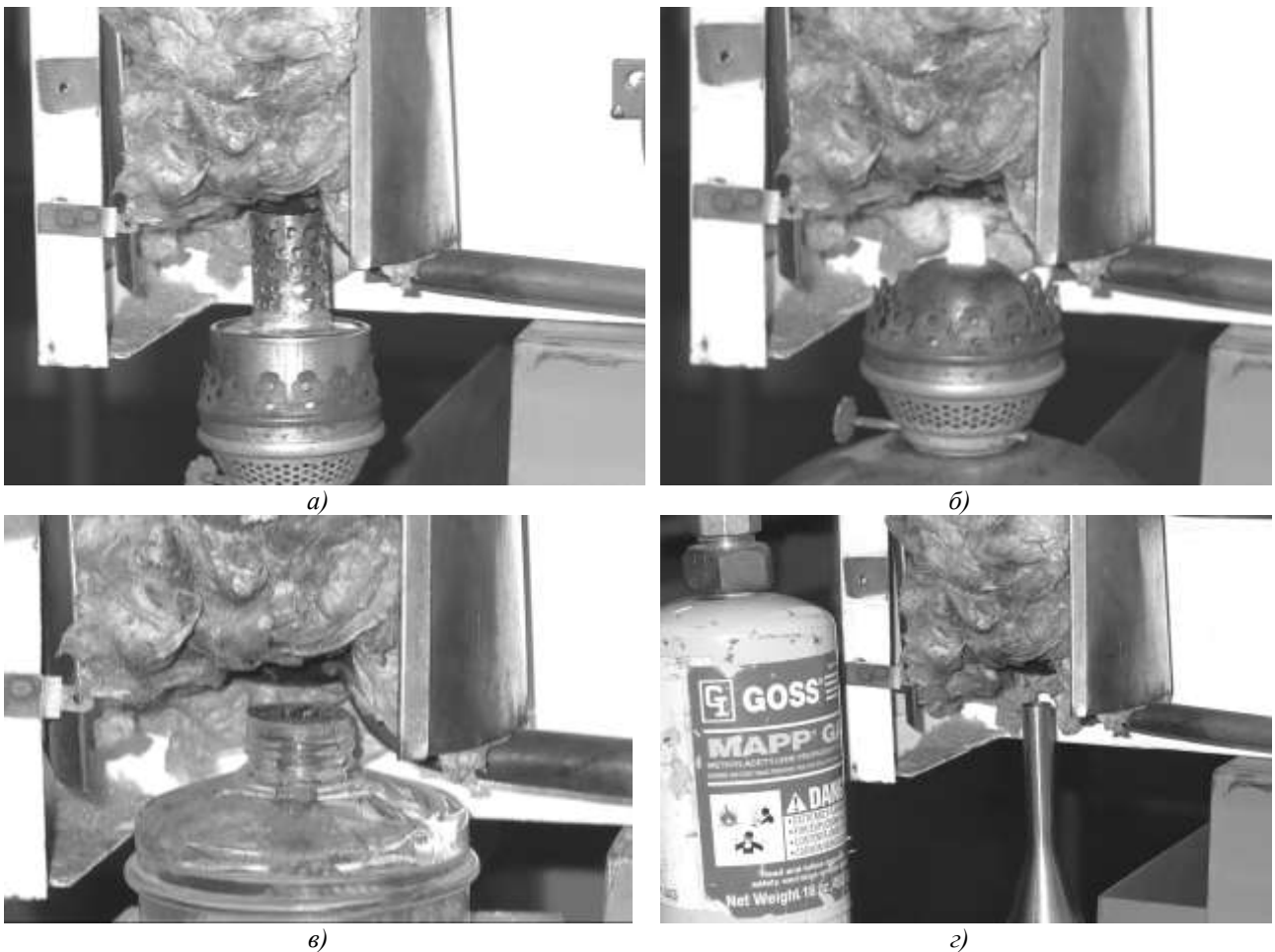
Рисунок 8 – Горелочные устройства в экспериментальных исследованиях: а) керосиновая лампа со стабилизатором пламени; б) керосиновая лампа без стабилизатора пламени; в) спиртовая горелка (лабораторная спиртовка); г) неспециализированная газовая горелка
